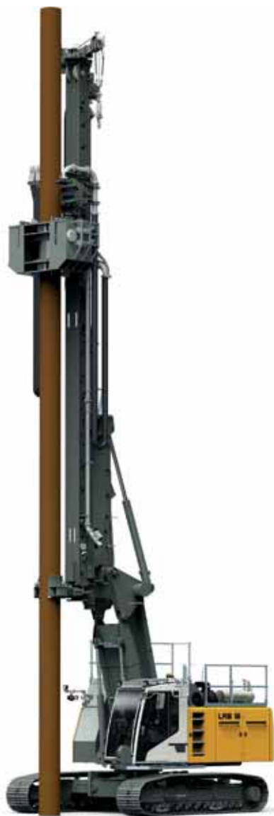
最大パイル長さ25 m
