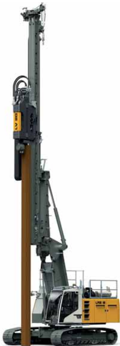
最大パイル長さ15.2 m
